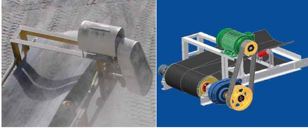
Şekil 4.4 Konveyörlerde kayış kasnaklı tahrik mekanizması
