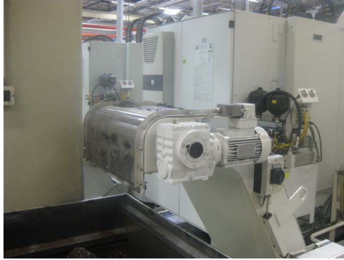
Şekil 3.20 Talaş konveyöründe boşaltma sistemi (Bosch REXROTH) [12]
