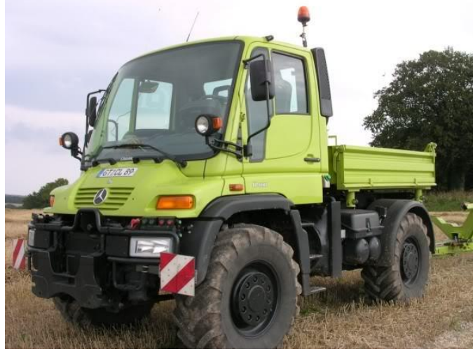
Şekil 3.4 Sürücü otuma yeri önde olan traktör(Mercedes Unimog)
