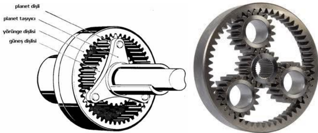
Şekil 6.11 Basit planet mekanizması
