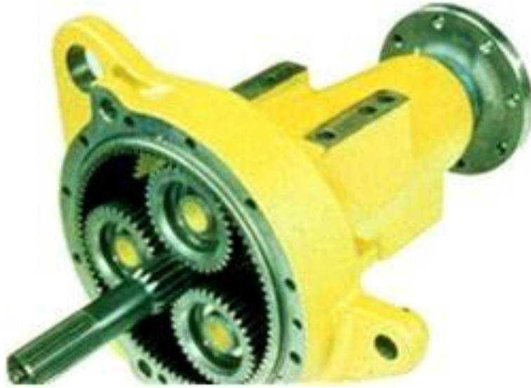
Şekil 6.19 JOHN DEERE planet mekanizmalı son redüksiyon
