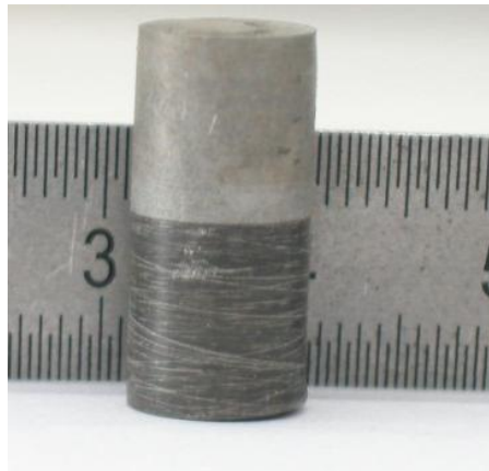
Şekil 6.1 540°C'de 3 MPa basınç ve 90 dakika süre ile difüzyonla birleştirilen 2124/SiC/17p–380 Al numune çiftine ait makrograf
