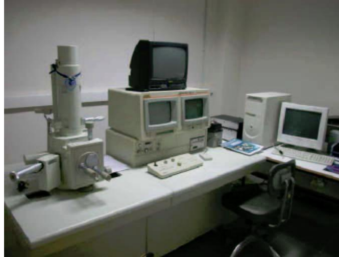
Şekil 5.15 SEM incelemelerinde kullanılan Jeol JSM 5410 LV marka tarama elektron mikroskobu
