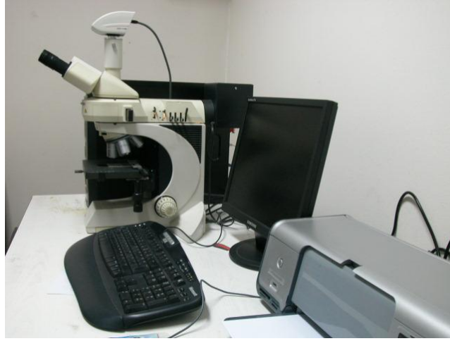
Şekil 5.14 Metalografi incelemelerinde kullanılan Leica Image Analyser cihazı
