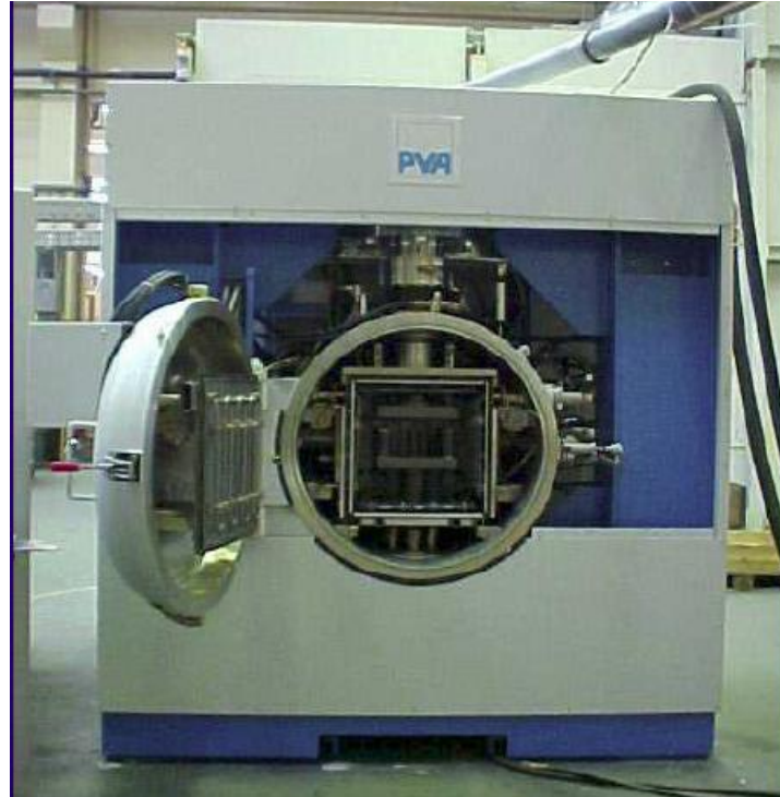
Şekil 3.12 Difüzyonla birleştirme işlemlerinde kullanılan vakumlu sıcak pres [95]
