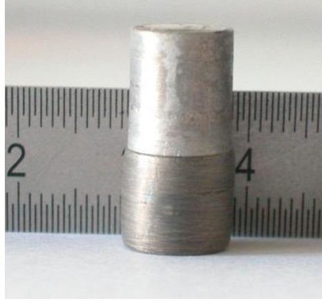
Şekil 6.2 560°C'de 3 MPa basınç ve 30 dakika süre ile difüzyonla birleştirilen 2124/SiC/17p-380 Al numune çiftine ait makrograf
