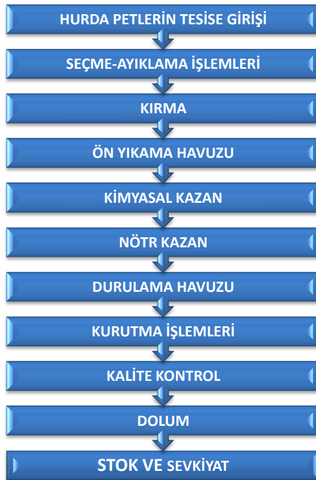
Şekil 6.4 PET'in mekanik geri dönüşümü akım şeması
