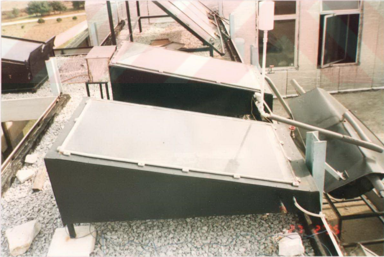
Şekil 4.1. TÜBİTAK-MAM'nde imal edilmiş iki adet havuz tip damıtıcı
