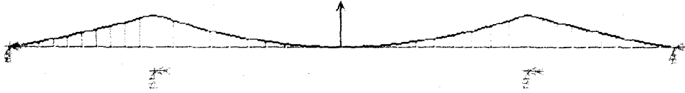
Şekil 3.4 Tacoma Narrow Köprüsü'nün sınır koşulları ve yükleme durumu
