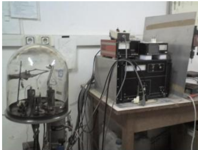
Şekil 3.5 Y.T.Ü Fizik Bölümü Katıhal Elektroniği Laboratuvarında bulunan elektron demeti Buharlaştırma Vakum Sistemi
