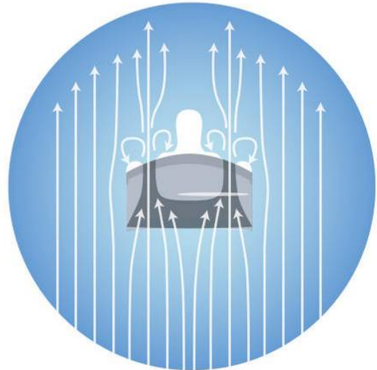
Şekil 4.18. Pearl River Tower 'da Kullanılan Darrieus Rüzgar Tipi Türbini ve Tasarım Yaklaşımı (16)
