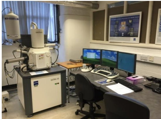
Şekil 4. 8 ZEISS Ultra 55 marka FEG-SEM görüntüsü
