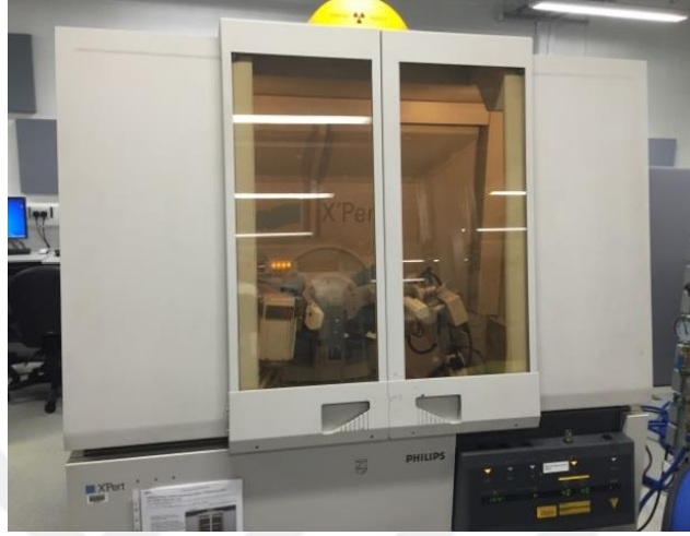
Şekil 4. 11 PANalytical marka XRD cihazı görüntüsü
