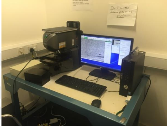
Şekil 4. 10 Keyence VK-X200K 3D marka KLM görüntüsü
