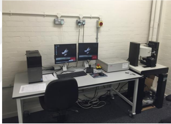
Şekil 4. 13 CSM marka mikro-indentasyon cihazının görüntüsü
