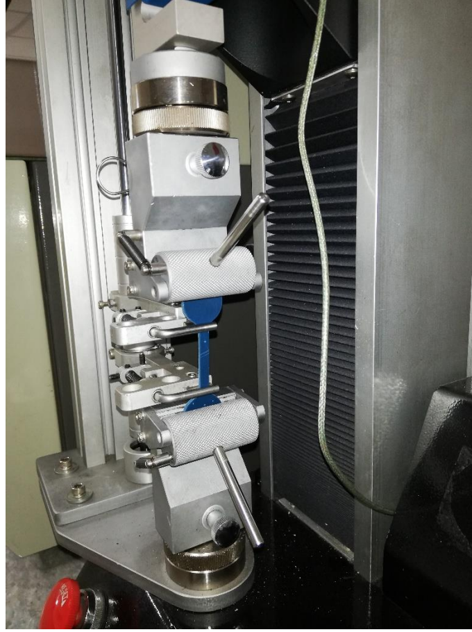
Şekil 4.1 Tek eksenli çekme cihazı
