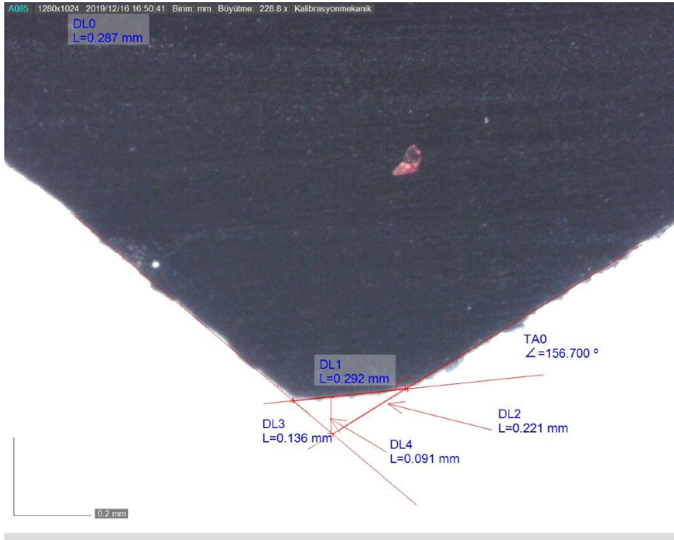
Şekil 6.14 3000 dev/dak 'da çalışmış keçe detayı (2.bölge)
