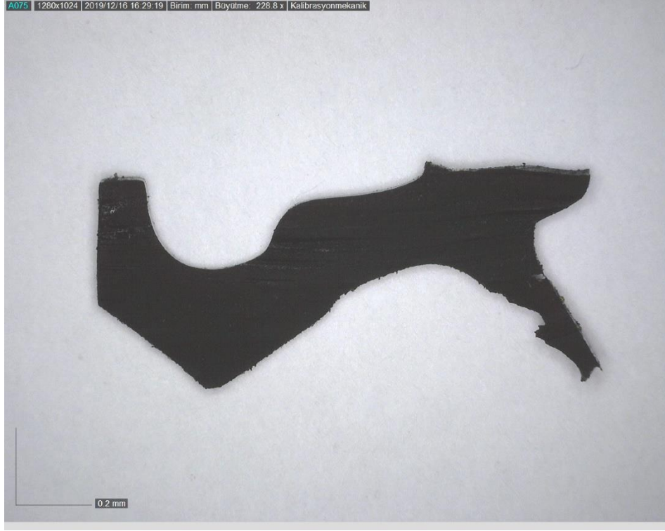
Şekil 6.15 3000 dev/dak 'da çalışmış keçe (3.bölge)
