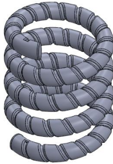
Şekil 2.5 Koruge yüzeyli helisel boruya ait çizim
