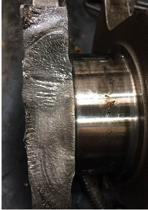
Şekil 2.5 Yüksek tekrarlı eğilme yükü kaynaklı krank mili hasarı
