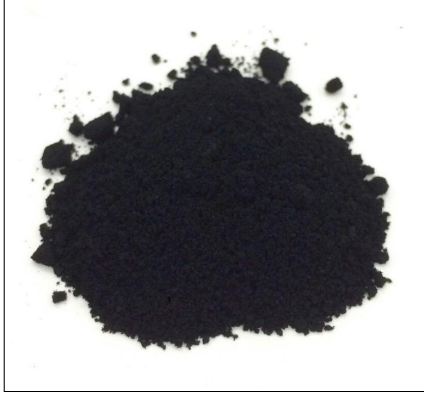
Şekil 2. 1 Çok cidarlı karbon nanotüp numunesi
