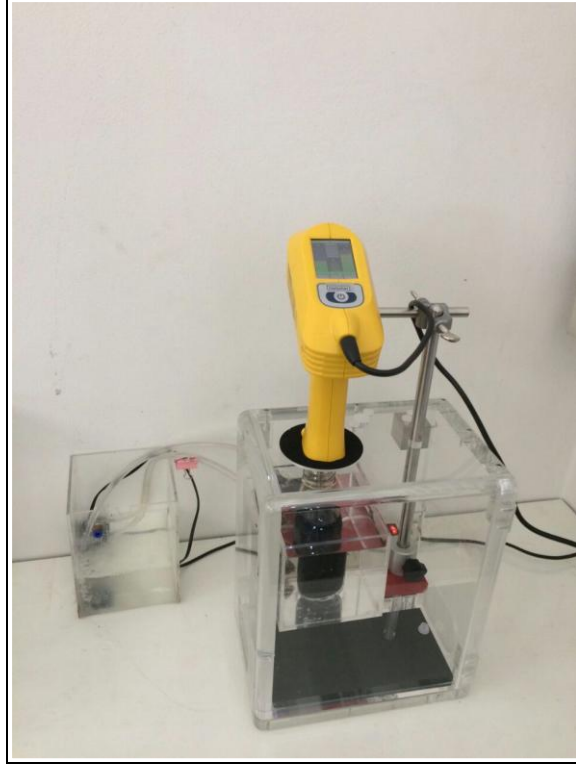
Şekil 2. 4 Sonikasyon işlemi için kurulan düzenek ve ultrasonik sonikatör
