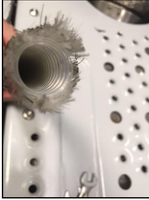
Şekil 3. 4 Flex hortumun içyapısı
