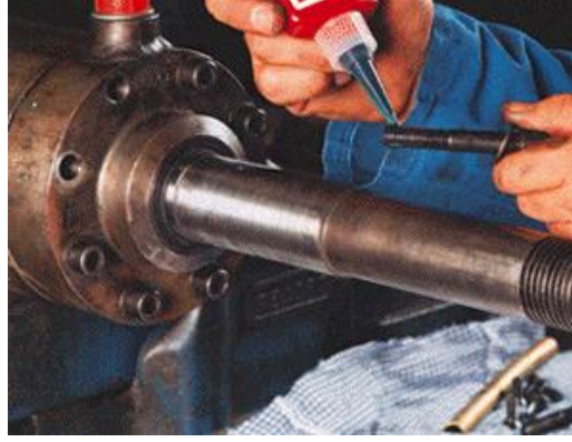
Şekil 2.7 Cıvataların çözülmeye karşı yapıştırıcı ile emniyete alınması [39]
