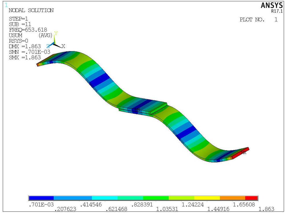
Şekil 3.8 11. Mod Şekli (Enine titreşim hareketi)
