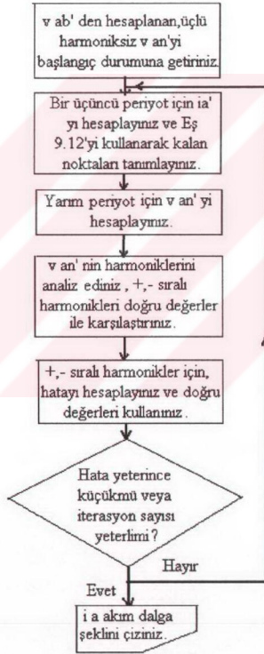
Şekil 7.13 Topraksız yıldız bağlantının akış şeması
