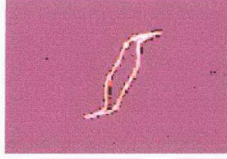
Şekil 5.4 Üç faz geriliminde ölçülen, \Delta - \Delta üç faz transformatörün A fazındaki histerezis eğrisi
