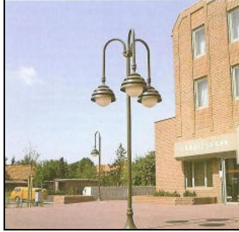
Sekil 5.12 Isığın yatay düzlemin üzerine gitmesini engelleyen küresel aydınlatma elemanı örneği
