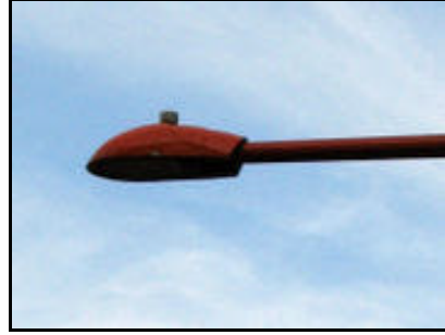
Sekil 5.10 Isigi dolaysiz olarak asagi gönderen, yatay düzlemin üzerine isik göndermeyen bir aydinlatma elemani
