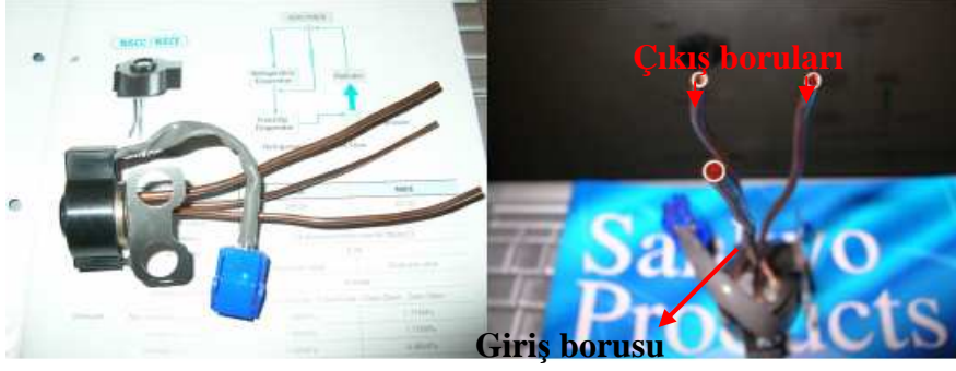
Şekil 4.4: Oransal kontrollü valf
