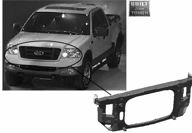
Şekil 5.15 Radyatör desteği (Li, 2004)
