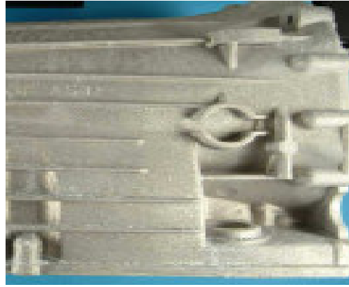
Şekil 7.13 AS31 HP'den imal edilmiş otomatik şanzıman kutusu kesiti korozyon testi sonrası görünümü
