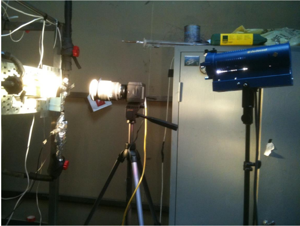
Şekil 6.60 Işığın kamera ile aynı yönde yerleştirilmesinin fotoğrafı
