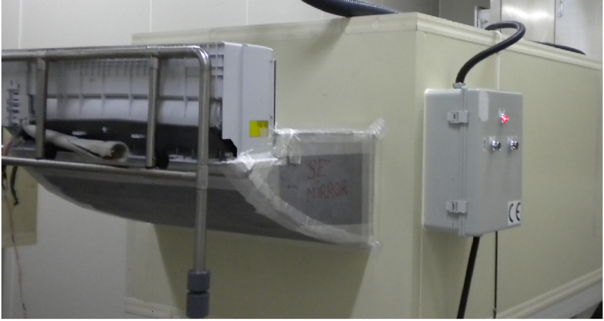
Şekil 3.3 İç ünite debi ölçümü
