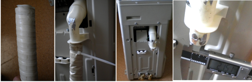
Şekil 2.50 Havalandırma/nemlendirme borusu bağlantısı
