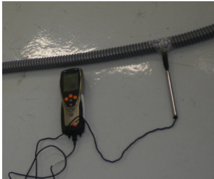
Şekil 4.1 Taze hava kanalında debi ölçümü yapılan anemometre
