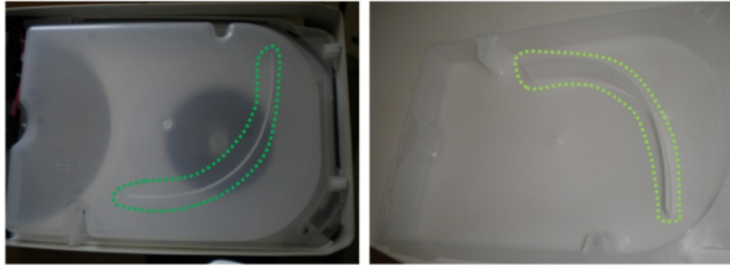
Şekil 2.54 Fanı ve nem tutucuyu kapatan kapak
