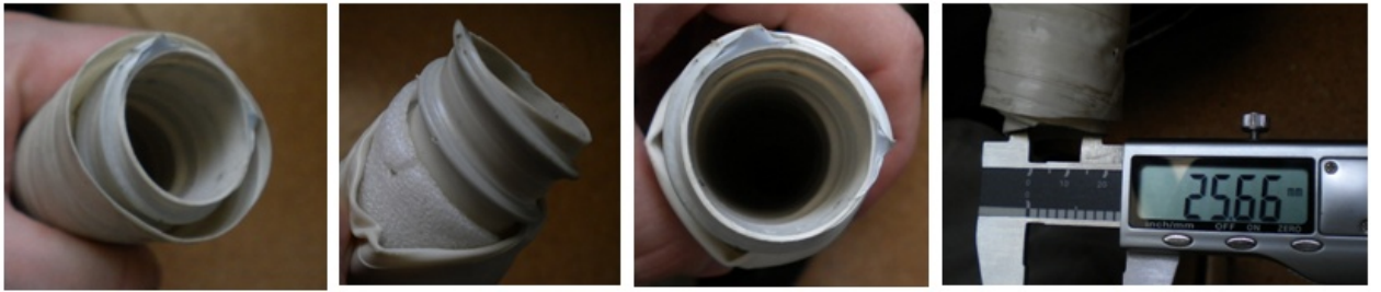
Şekil 2.51 Taze hava borusunun yapısı
