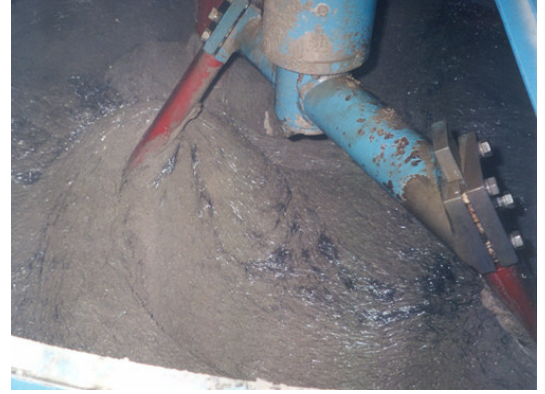
Şekil 4.19 Çelik şeritlerle takviye edilen beton kendi kendine sıkışabilme özelliğine sahiptir (Ties Rijcken)
