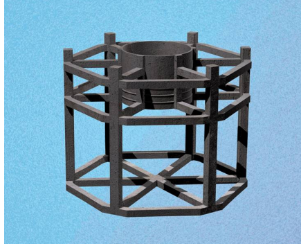
Şekil 4.18 Kapasitesi artırılmış temel iskeleti (Ties Rijcken)
