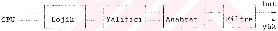
Şekil 4.3. Çıkış devresi blok şeması.
