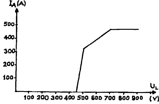
Şekil 6.6 Güç durumunda armatür akımı ile hat gerilimi arasındaki grafik.
